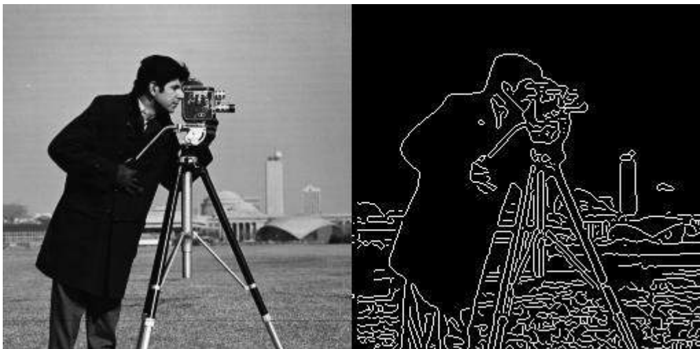
Figura 2.8. Detección de bordes mediante el operador de Canny.
