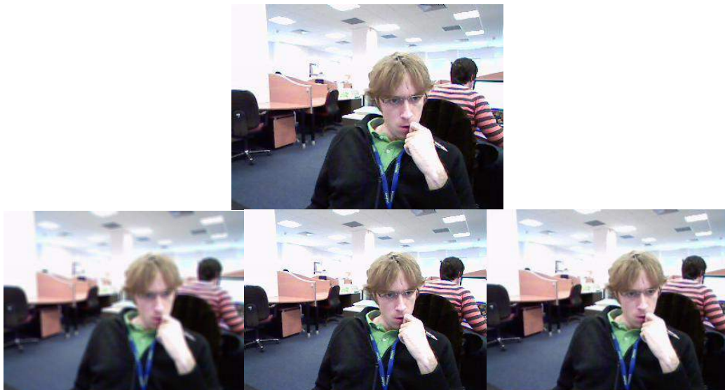
Figura 5.3. Efecto de aplicar diferentes filtros clásicos. En la parte superior, la imagen original. De izquierda a derecha, filtro de media 5x5, filtro de mediana 5x5 y filtro gaussiano 5x5.
